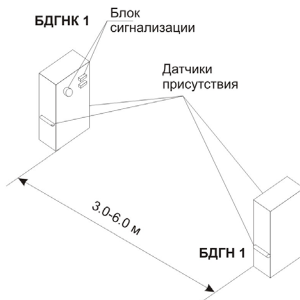
Рисунок 1.9 – Расположение блоков УПК-PM5000A-09
