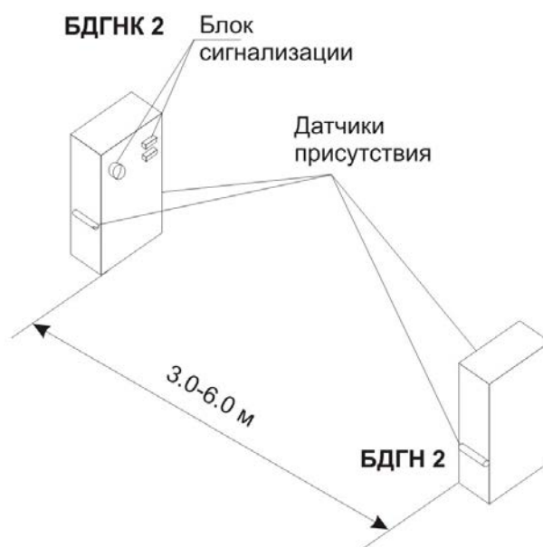
Рисунок 1.10 – Расположение блоков УПК-PM5000A-09H
